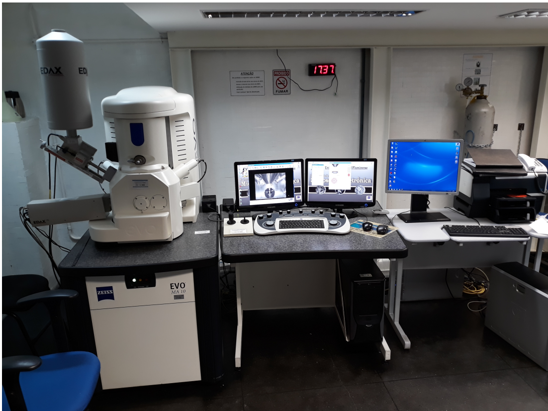
Figura 39 – Microscópio eletrônico de varredura utilizado na caracterização microestrutural dos aglomerados.
