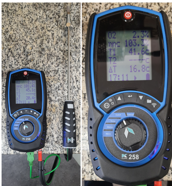
Figura 37 – Analisador de gases CO/CO 2 e oxigênio, indicando baixa pressão deste último na atmosfera.
