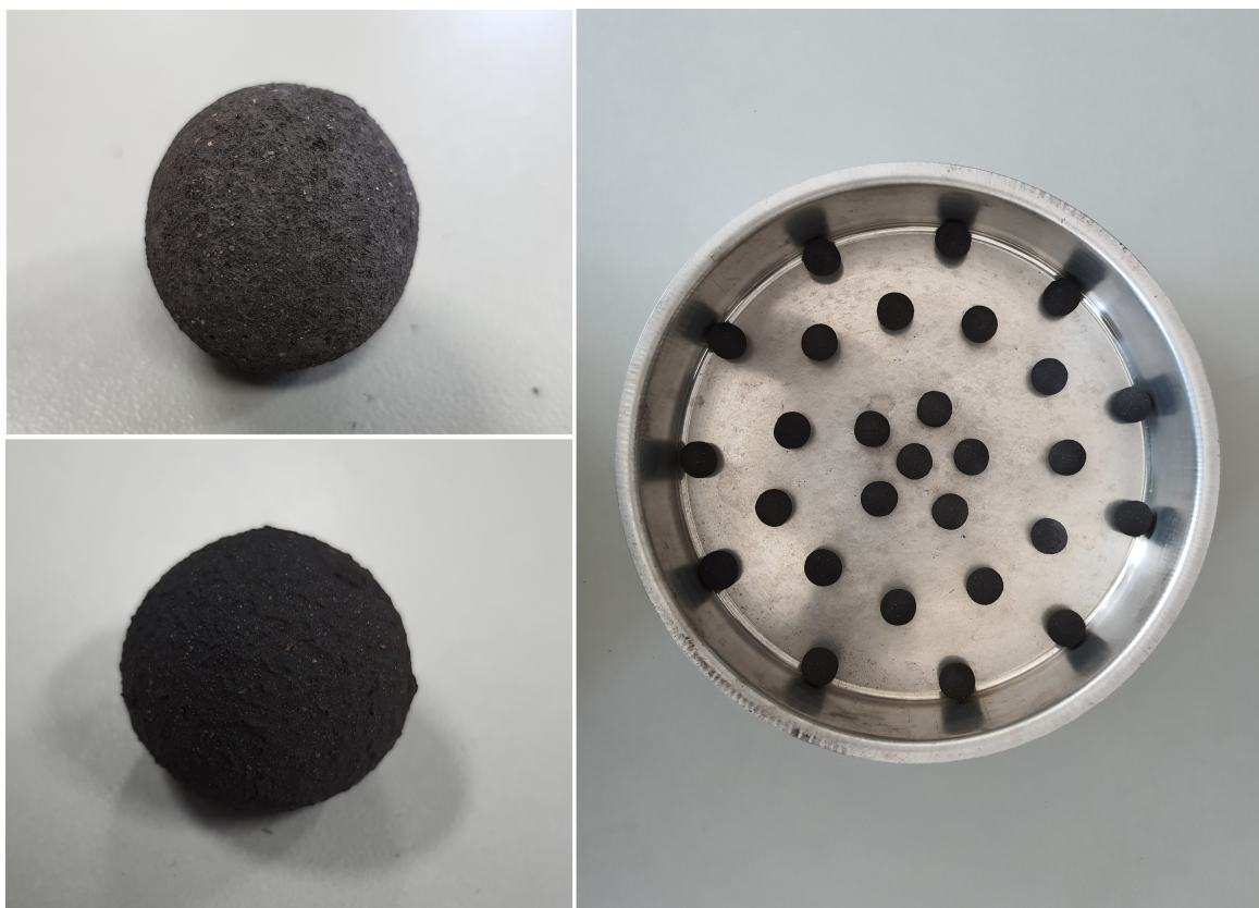
Figura 35 – Pelotas autorredutoras produzidas a partir de misturas com diferentes teores de biomassa para os ensaios termogravimétricos.
