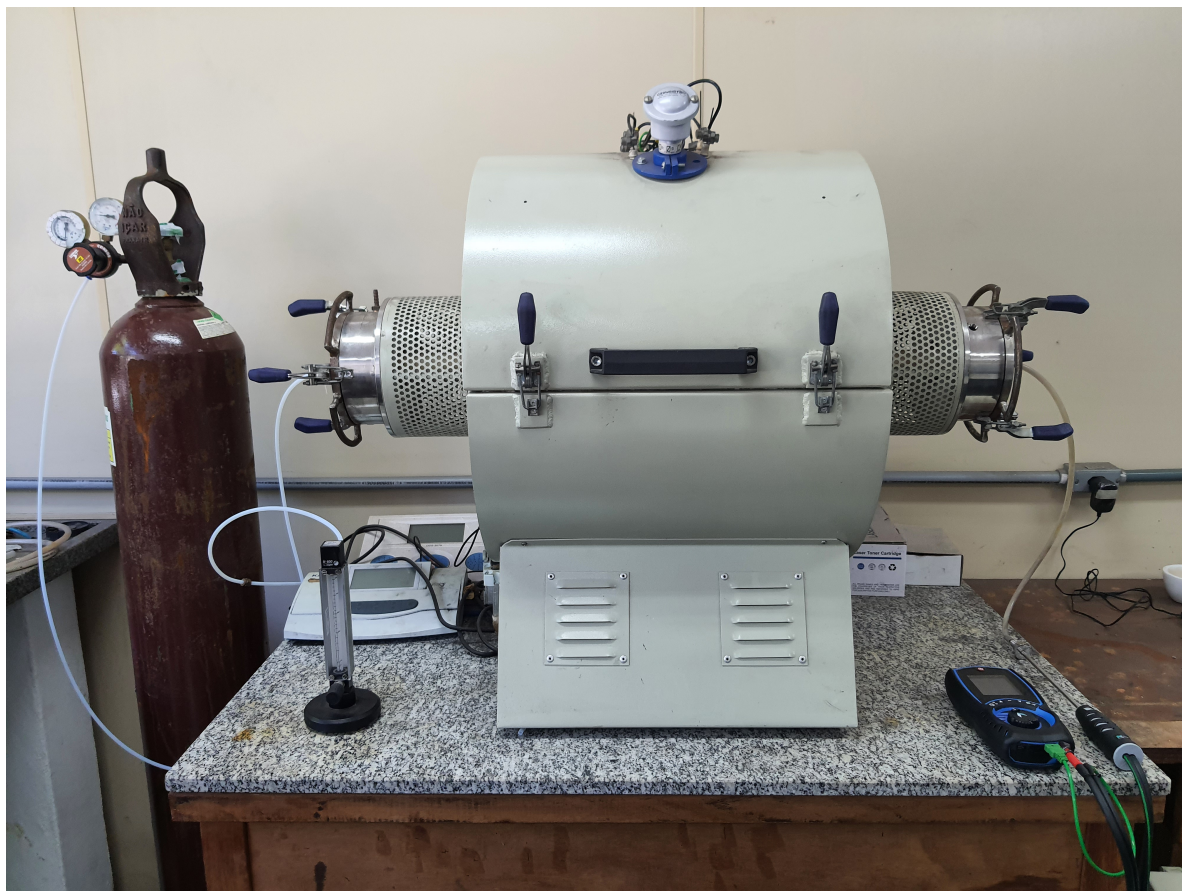
Figura 36 – Aparato constituído por forno tubular, vazão de gás inerte (argônio) e analisador de gases de saída utilizado para realização dos ensaios termogravimétricos.
