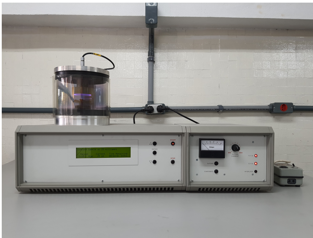
Figura 40 – Equipamento EMITECH K550 utilizado na metalização da superfície das amostras.
