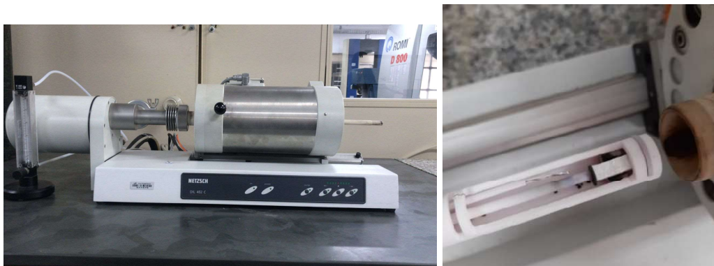
Figura 15 - a) Dilatômetro Netzsch DIL 402 C utilizado neste trabalho, b) Detalhe da acomodação da amostra para realização da dilatometria.
